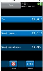
Fig. 42: Wood moisture test
