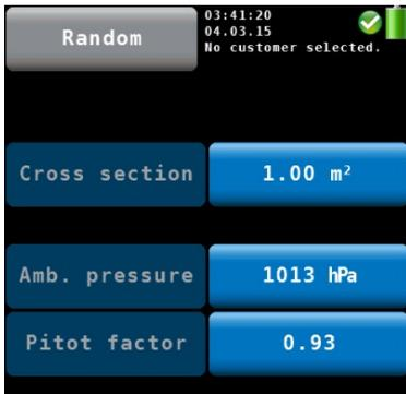
Fig. 36: Setup > Flow Parameter
