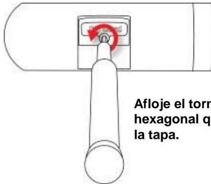
Afloje el tornillo hexagonal que fija la tapa.
