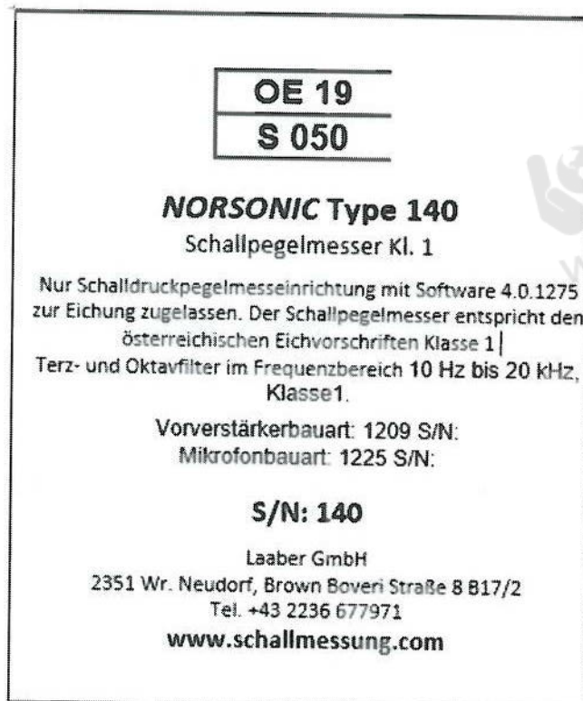
Muster eines Typenschildes nach 6.1
