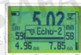
Cambio rápido de modo de medición, Normal o sobre pintura.
