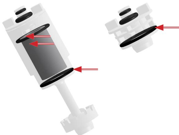
2. Las seis juntas presentes en el conector de la sonda de extracción de humos y en el conector de su extensión.
