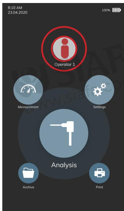
Para seleccionar el operador, mantener presionado el operador deseado en la pantalla del analizador. Éste se volverá de color amarillo.
