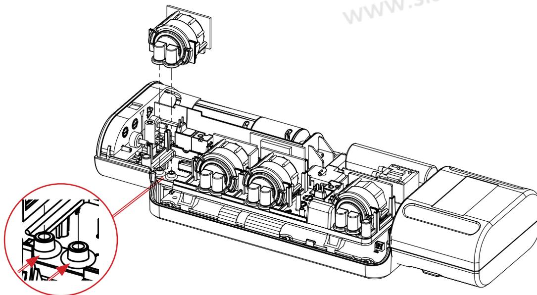
**Al retirar el sensor es posible que las dos juntas tóricas permanezcan dentro del conector del analizador (véase ejemplo); si así fuera, es necesario retirarlas.**
