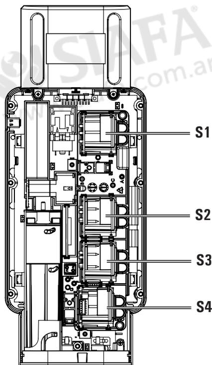
3. Una vez identificado el sensor de oxígeno, empujar hacia arriba el sensor (el ejemplo se refiere al sensor en posición 4).
