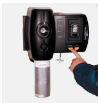
Prueba funcional de ToxiRAE 3 con estación de Calibración y prueba funcional de AutoRAE Lite
