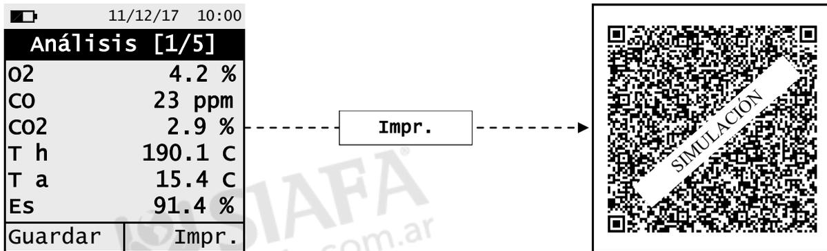
**ESCANEE EL CÓDIGO QR USANDO LA APP “CHEMIST QR CODE”, PARA DESCARGAR LOS DATOS OBTENIDOS DEL ANÁLISIS DE COMBUSTIÓN.**
