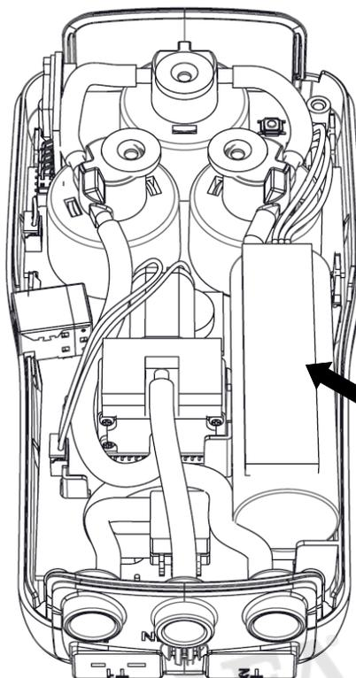
**3** Desconecte el conector de la batería, sustituya la batería por la nueva y vuelva a conectar el conector de la misma en su posición.
